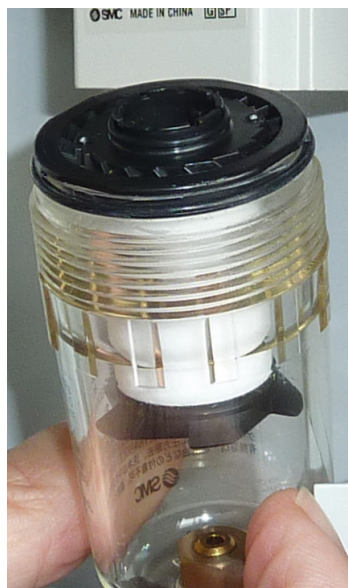
Bild 4 - 4 Ansicht mit entferntem Filtergehäuse
