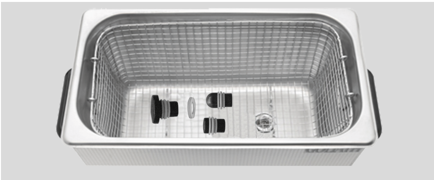
Bild 9 - 9 Ultraschallbad mit V-ACTOR Transmittern
